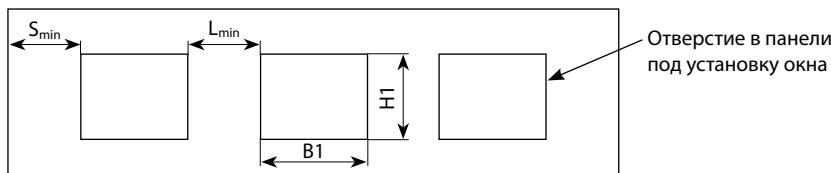
В панели с рисунком наружной поверхности микроволна и S-гофр высотой 500 и 625 мм, М-гофр и L-гофр высотой 500 мм устанавливаются окна арт. W043WH-TG40, W043WH-CG40, W043BR-TG40, W043BR-CG40, W050WH-40, W050BR-40, W060WH-40, W060BR-40, W046-40, W085-40, W095-40, W51SS-40, W61SS-40.
