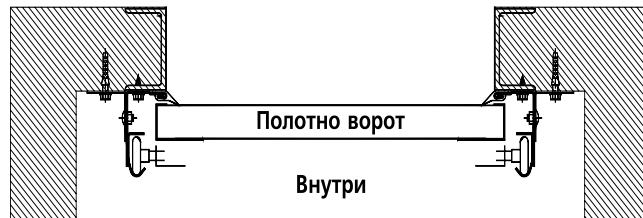
При невозможности установки металлического обрамления проема крепление ворот следует производить при помощи стяжных шпилек.
