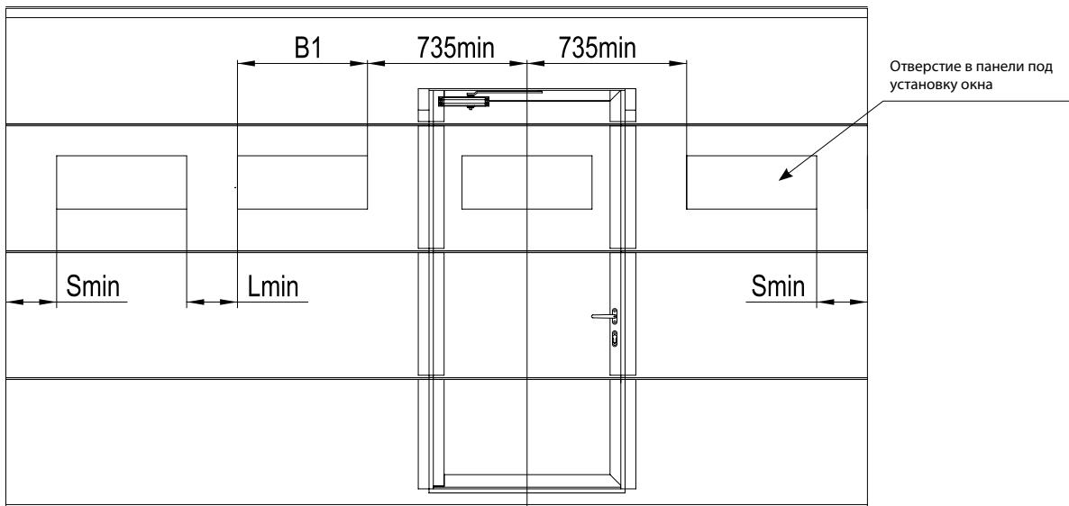
**Внимание!** Врезка окон в верхнюю калиточную секцию полотна ворот должна согласовываться заказчиком и выполняется только при технической возможности.
