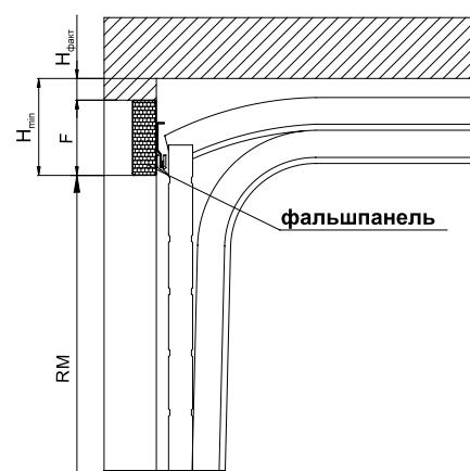
Ворота с торсионными пружинами.
