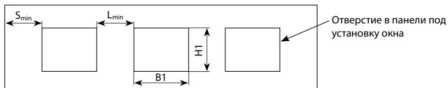
В панели с рисунком наружной поверхности микроволна и S-гофр высотой 500 и 625 мм, М-гофр и L-гофр высотой 500 мм устанавливаются окна арт. W043WH-TG, W043WH-CG, W043BR-TG, W043BR-CG, W050WH, W050BR, W060WH, W060BR, W046, W085, W095.
