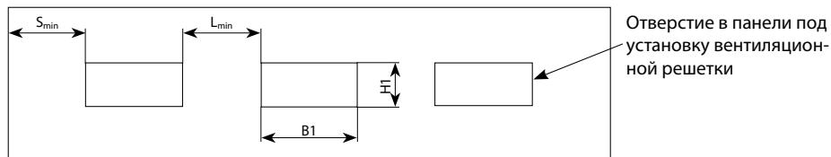
В верхнюю панель вентиляционные решетки устанавливаются при высоте панели не менее 400 мм. Со стороны расположения засова решетка устанавливается на расстоянии не менее 1000 мм от края панели. Нестандартное расположение решеток должно согласовываться заказчиком в индивидуальном порядке. При наличии на панели ригельного замка установка вентиляционных решеток на данную панель не производится. В ворота с рисунком наружной поверхности панелей филенка вентиляционные решетки не устанавливаются.
