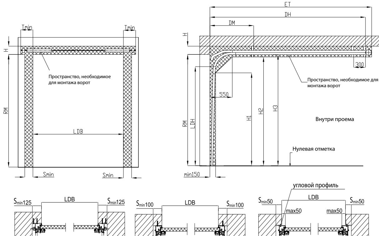
Минимальное боковое пространство (угловые стойки установлены за проемом, усиливающие кронштейны снаружи стоек)
