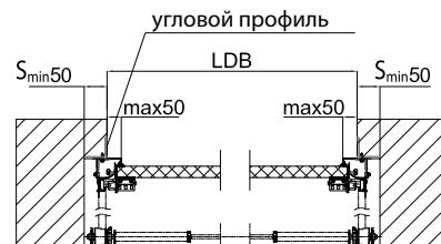
Минимальное боковое пространство (угловые стойки установлены за проемом, усиливающие кронштейны снаружи стоек)
