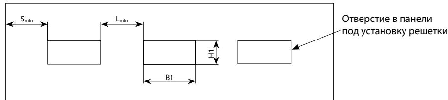
В верхнюю панель вентиляционные решетки устанавливаются при высоте панели не менее 400 мм.
