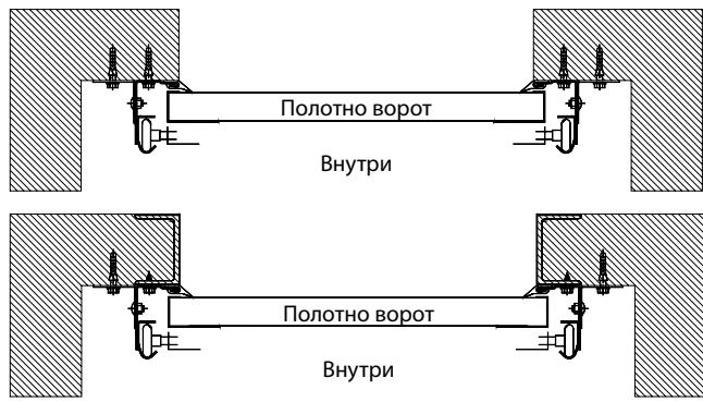
При невозможности установки металлического обрамления проема крепление ворот следует производить при помощи стяжных шпилек.
