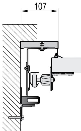
В случае отсутствия одного из боковых заплечиков применяется комбинированный монтаж, при котором одна вертикальная стойка ворот монтируется в проеме, а другая — за проемом.
