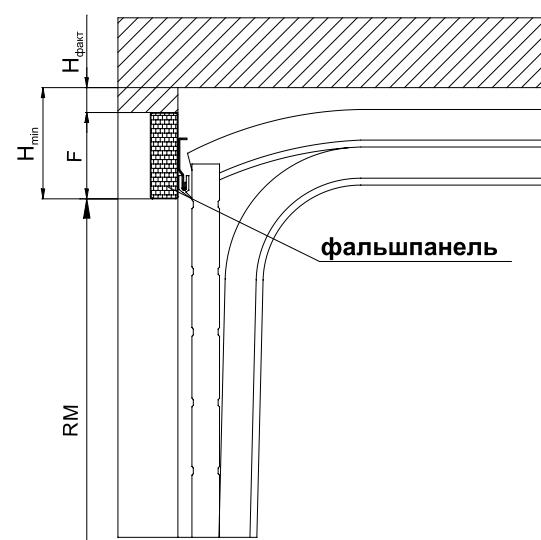
Ворота с тросионными пружинами. Низкий монтаж
