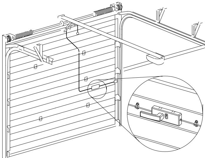
Рис. 5. Запирающее устройство и комплект троса разблокировки
