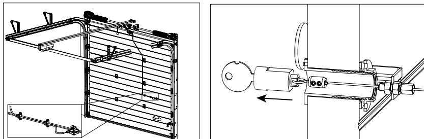
Рис. 6. Механизм разблокировки
