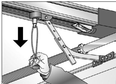
Рис. 4. Разблокировка электропривода изнутри помещения
